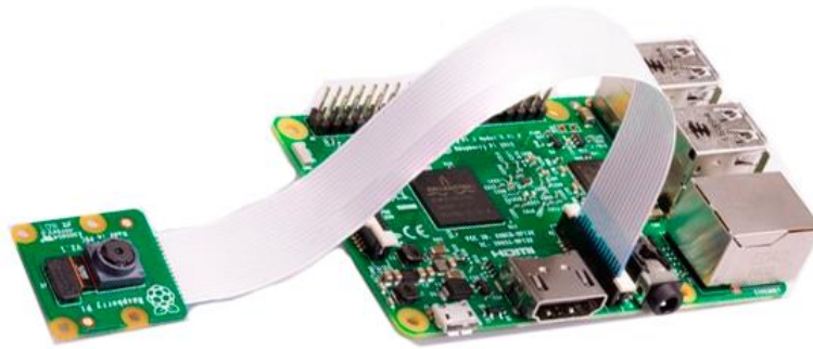
Figura 22. Conexión módulo cámara a Raspberry Pi V2 8MPX.
