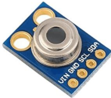
Figura 4 Imagen frontal del sensor MLX90614, Sensor Termómetro Infrarrojo MLX90614 En Board - DynamoElectronics (2020).
