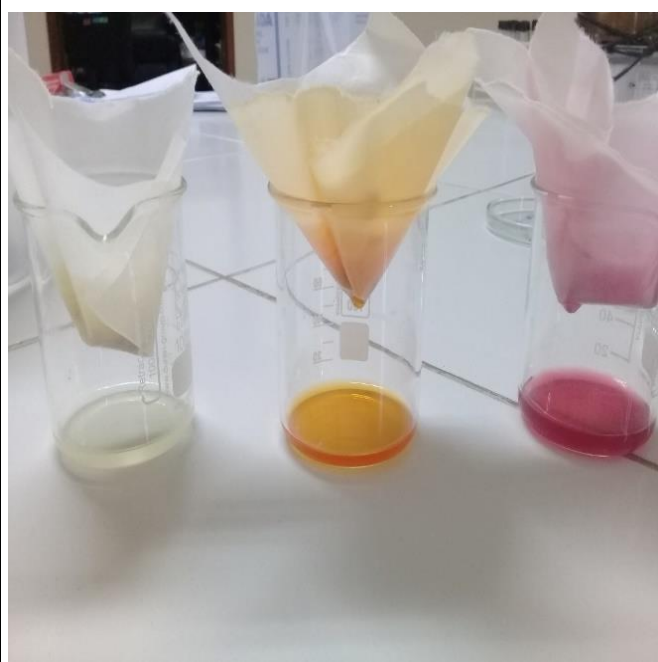
Imagen 17: Filtrado de muestra para determinar vitamina c.
