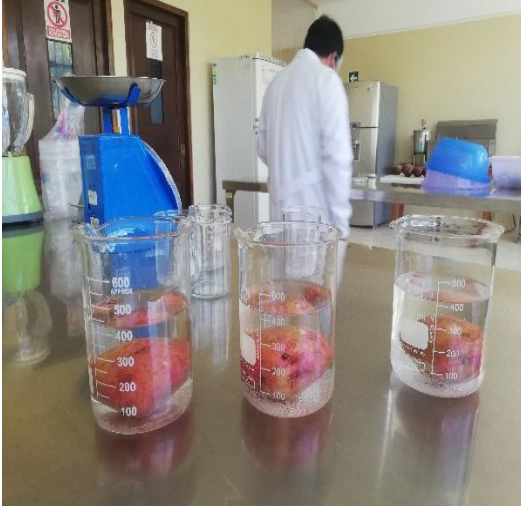
Imagen 2A. Determinación de gravedad específica
